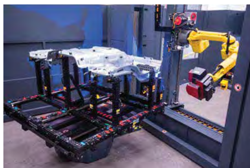
Figura 10: Fábrica de Solda – Célula de Medição Fonte: Arquivo da Empresa.
